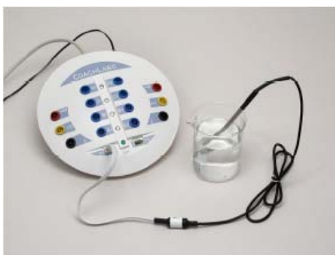
Rys. 1. Układ elektryczny do pomiaru temperatury wody.
